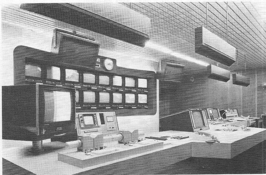
Regiekamer, met op de voorgrond de afstandbedieningen voor camera en episcoop en verder op de lessenaar de computergestuurde beeld- en geluidsmenger. Op de achtergrond de panoramische monitorwand.
